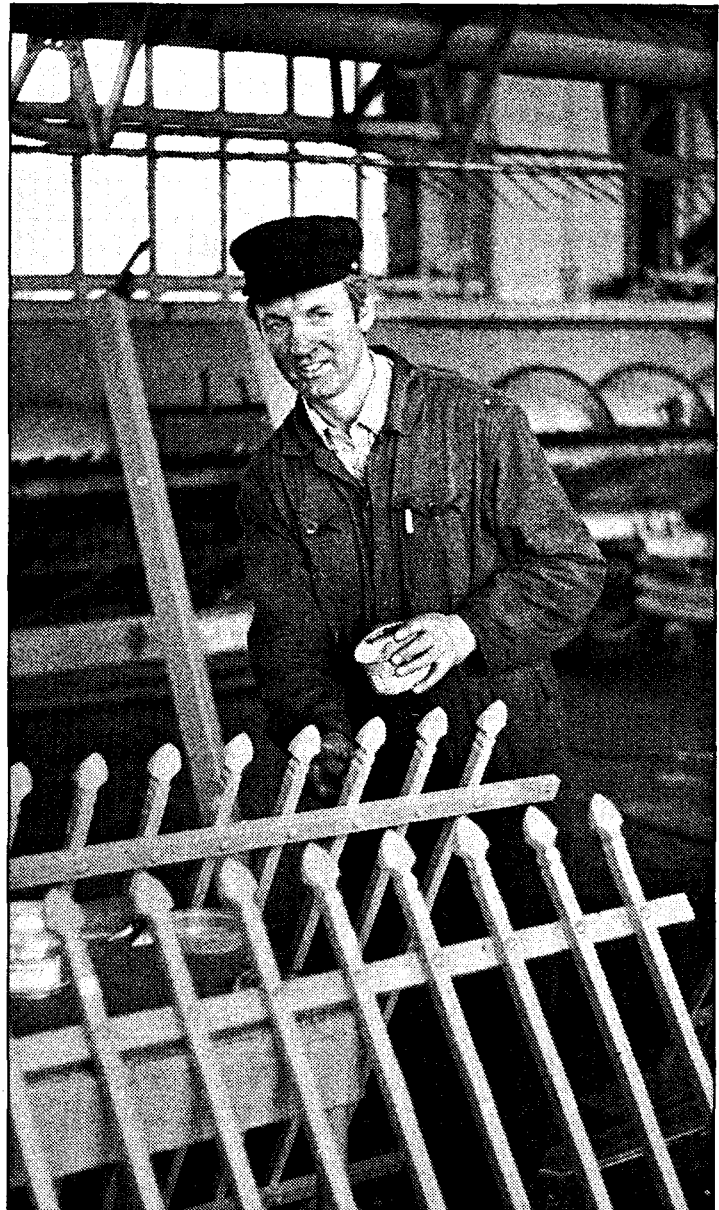
SPEZIALAUFTRAG: Ein altes Bild in einem Berliner Archiv diente als Vorlage zur Rekonstruktion dieses Ziergitters, das – neu erstanden in der ehemaligen LPG-Schlosserei – bald wieder den Putbuser Obelisken schmücken wird.
